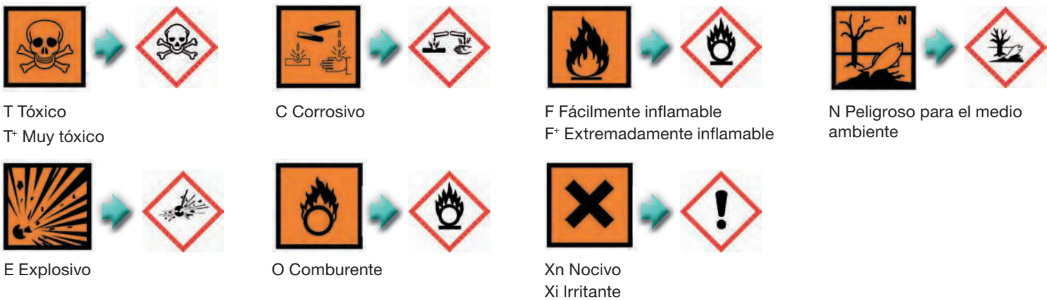
Fig. 5.14. Símbolos gráficos normalizados que avisan de peligros concretos en los materiales almacenados. Los antiguos pictogramas coexisten con los nuevos, dependiendo del tipo de producto, hasta 2012 en unos casos y hasta 2017 en otros.
